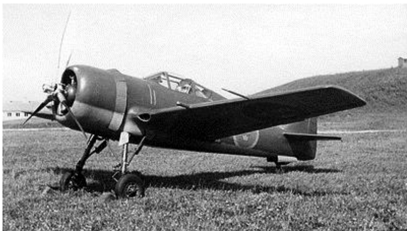
Flygplan J 22 och den svensktillverkade Twin Wasp motorn.
