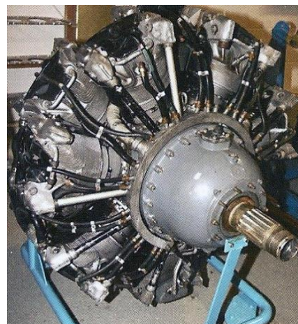
Flygplan J 22 och den svensktillverkade Twin Wasp motorn.
